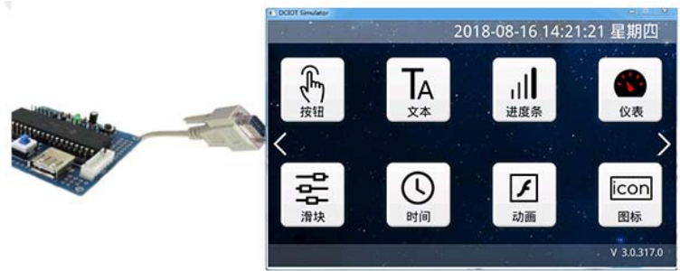
图 9-2 用户单片机串口与“虚拟串口屏”联机调试
